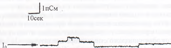
Рис. 7.5.3. Запись флуктуаций тока, протекающего через мембрану, при односторонней модификации леворином A_2 при потенциале 100 мВ (+ со стороны антибиотика). Концентрация антибиотика с одной стороны мембраны 5 \cdot 10^{-8} М. Водные растворы с обеих сторон мембраны содержат 2М КСl, рН 6,5, t=22^\circ\text{C} . Мембраны получали в смеси фосфолипида с холестерином в весовом соотношении 20:1. Стрелкой обозначен уровень проводимости немодифицированной мембраны [Kasumov et al., 1981; Ибрагимова и др., 2006 б].
