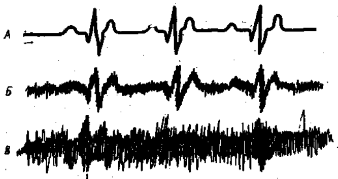
Рис. 7. Передача по линии связи электрокардиограммы больного в диагностический центр при разном уровне шумов. А — возможен полный анализ; Б — сигналы предсердного комплекса ниже уровня шума; В — отношение сигнала к шуму меньше единицы, анализ невозможен
