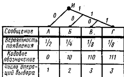
Рис. 6. Количественная оценка информационных операций при передаче сообщений с разной вероятностью их появления. И — исходное состояние; А — Г — сообщения; цифры на соединительных линиях — выбор в двоичном коде (0—1)
